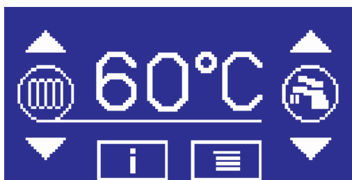
ZOBRAZENÍ TEPLoty TOPNÉ VODY
