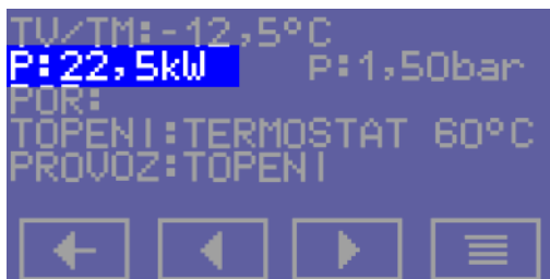
P: OKAMŽITÝ VÝKON KOTLE
