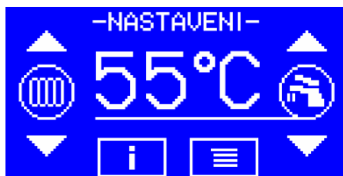
NASTAVOVÁNÍ ŽÁDANÉ HODNOTY TEPLoty TUV
