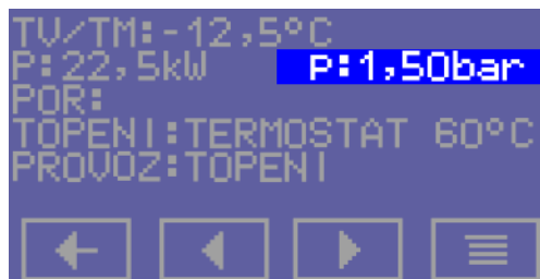
p: TLAK V OTOPNÉ SOUSTAVĚ
